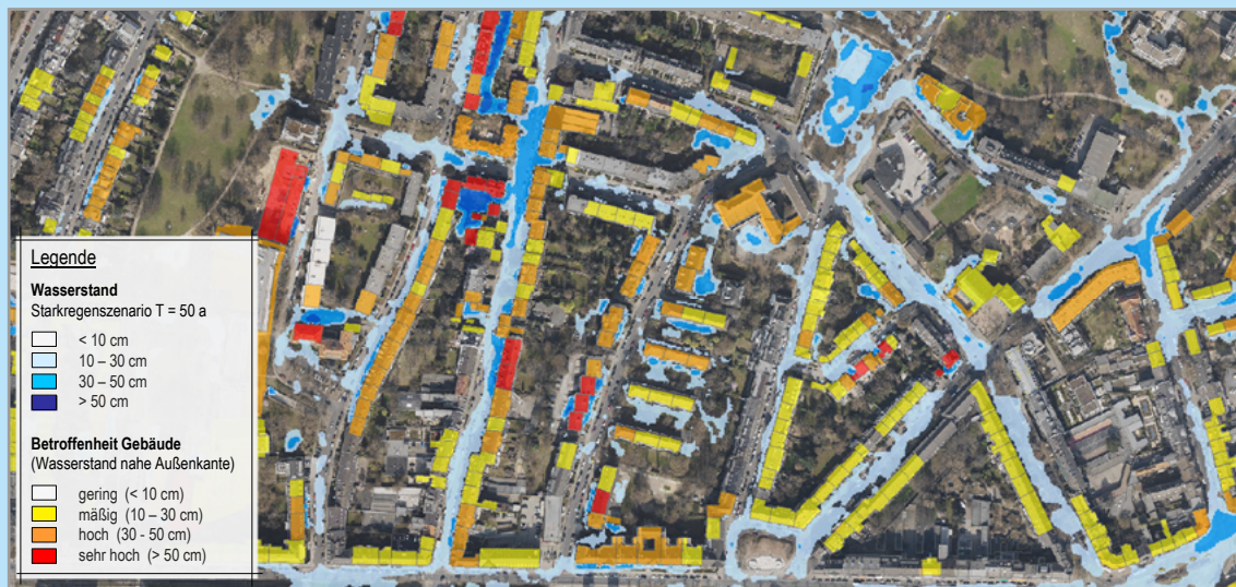
Abbildung 6.2: Beispiel einer vereinfachten Risikokarte mit klassifizierter Kennzeichnung des Wasserstandes ( T_n = 50 a) und der Betroffenheit aufgrund der Nähe zum Wasserstand (Illgen 2015)
